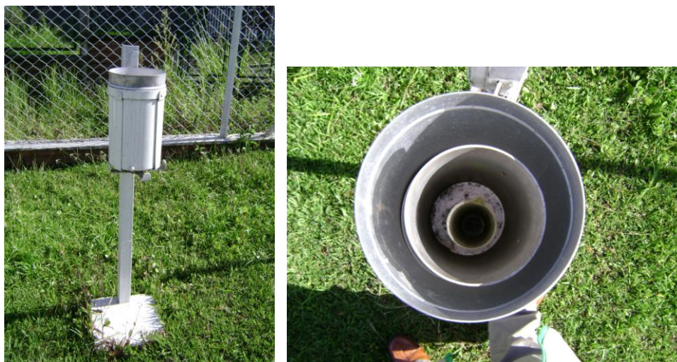
Fig. 1 Pluviómetro (PM), versión Hellmann
