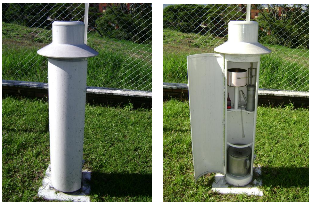
Fig.2. Pluviografo versión Hellmann
