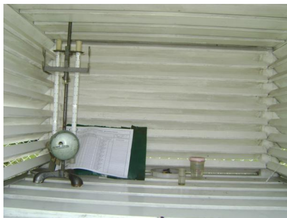
Fig. 5 Caseta Meteorológica en la cual se dispone el Psicrómetro.
