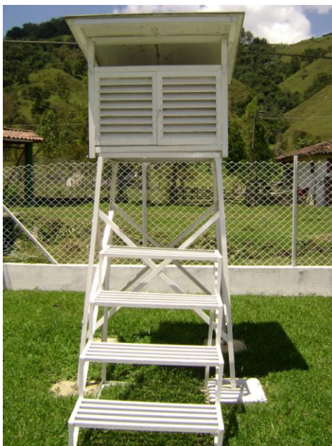
Fig. 5 Caseta Meteorológica en la cual se dispone el Psicrómetro.
