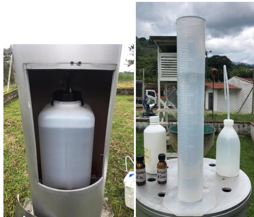
Toma de muestras en colectores de agua lluvia
