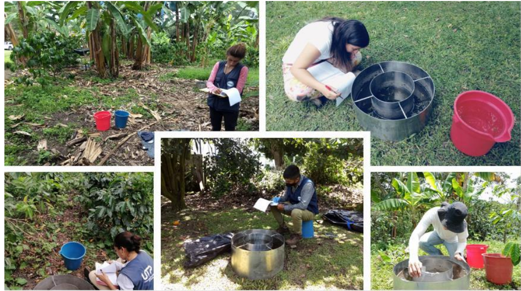
Pruebas de infiltración
