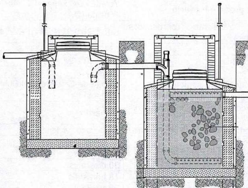
Imagen 1. Esquema corte de Tanque Séptico y FAFA.
