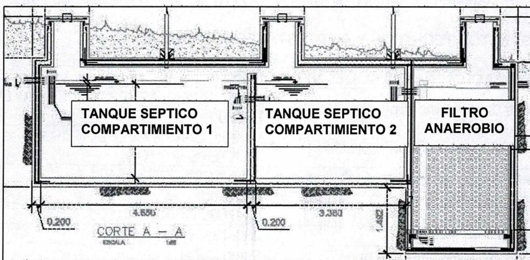
Imagen 1. Esquema Sistema de Tratamiento Aguas Residual Domestica
