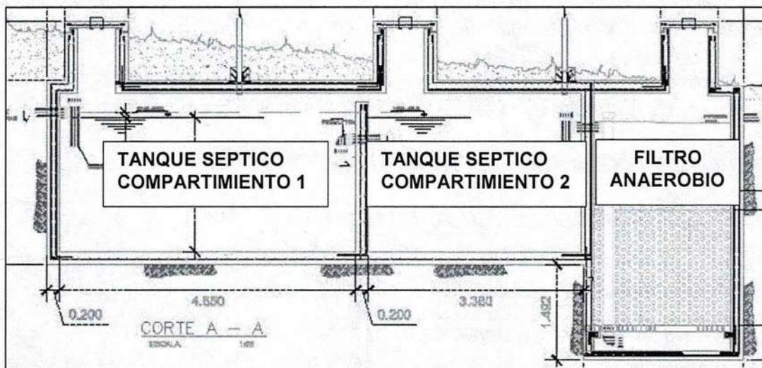
Imagen 1. Esquema Sistema de Tratamiento Aguas Residual Domestica
