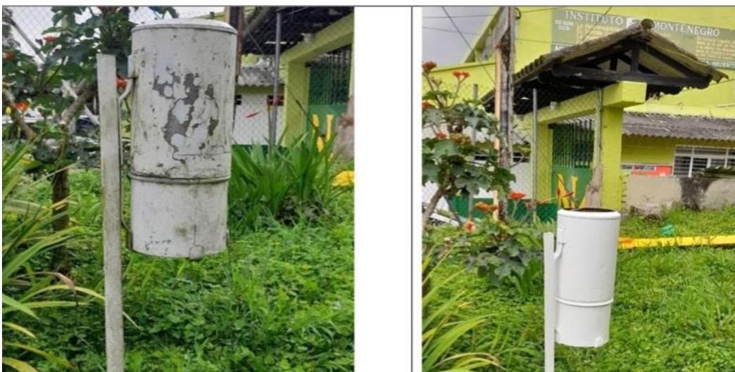
**Antes y después del mantenimiento al pluviómetro de la estación Instituto Montenegro**
