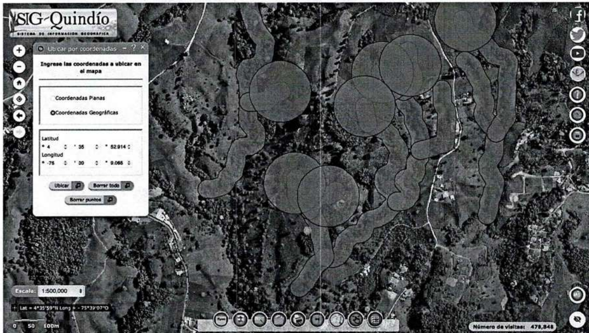
Imagen 5. Suelos de protección alrededor del punto de descarga Fuente: SIG Quindío
