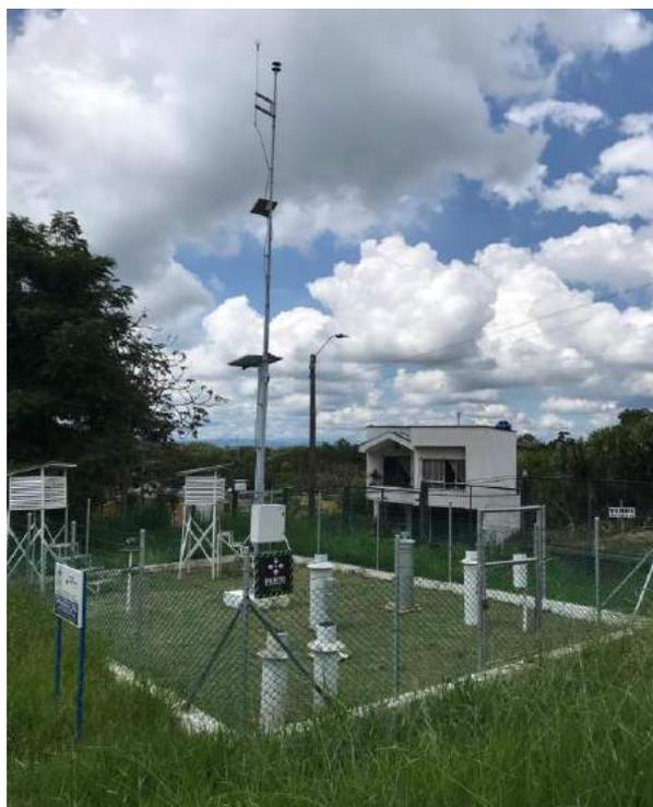
Fotografía 2. Estación Meteorológica Automática CRQ
