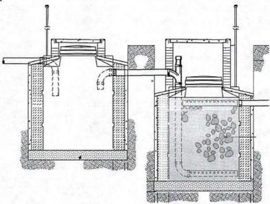
Imagen 1. Esquema corte de Tanque Séptico y FAFA.
