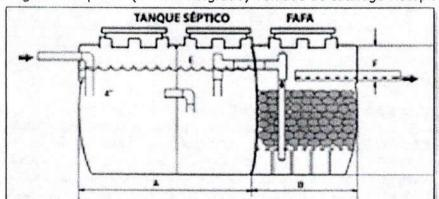
Imagen 1. Esquema (STARD integrado) Tomado de catálogo Rotoplast
