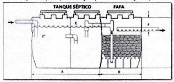
Imagen 1. Esquema (STARD integrado) Tomado de catálogo Rotoplast
