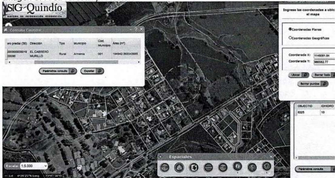
Según el punto de posible afloramiento de agua encontrado en el SIG quindío se estableció un Buffer de 100 m a la redonda, y se verificó la coordenada de descarga propuesta en planos Este: 1.146.091,84 m Norte 986.582.77, encontrando que se ubica por fuera de área forestal protectora buffer de 100m según Decreto 1076 de 2015, en el cual se establece que, para la protección de los bosques, los propietarios de predios están obligados a:
