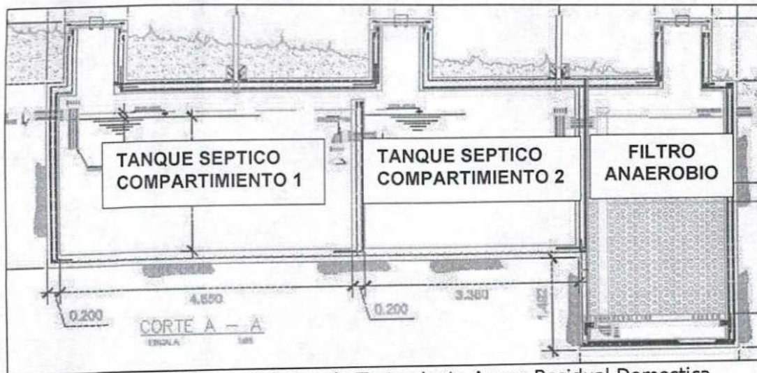
Imagen 1. Esquema Sistema de Tratamiento Aguas Residual Domestica
