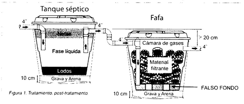
**Filtro Anaerobio de Flujo Ascendente FAFA:** En el predio se encuentra instalado un tanque prefabricado de polietileno marca rotoplast, y según el catalogo del fabricante las
