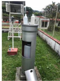
Colector de agua lluvia para isotopia Estación Centro de la Guadua
