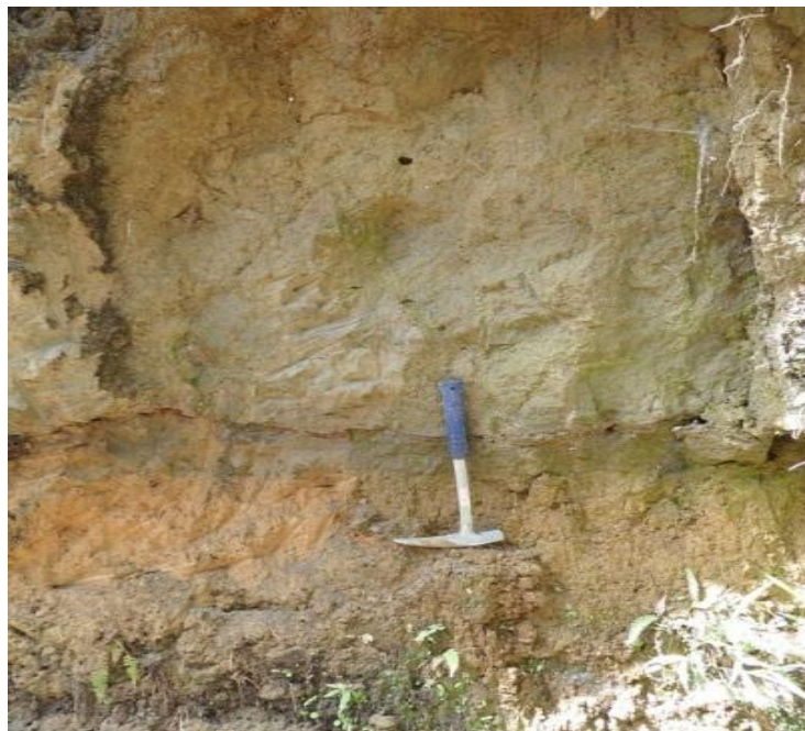
Figura 2.4. Ejemplo de una sección del Abanico del Quindío, constituido por un flujo lodoso, localizado en el sector de Trocaderos, municipio de Quimbaya, donde se nota el carácter lodoso dominante del depósito y las variaciones en los procesos de sedimentación (Foto: Néstor Martínez, 2012).
