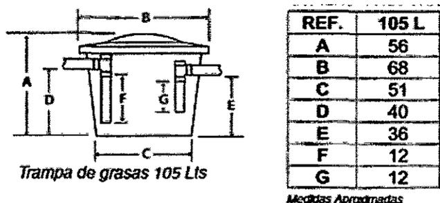
**Imagen 1. Trampa de grasas prefabricada**
