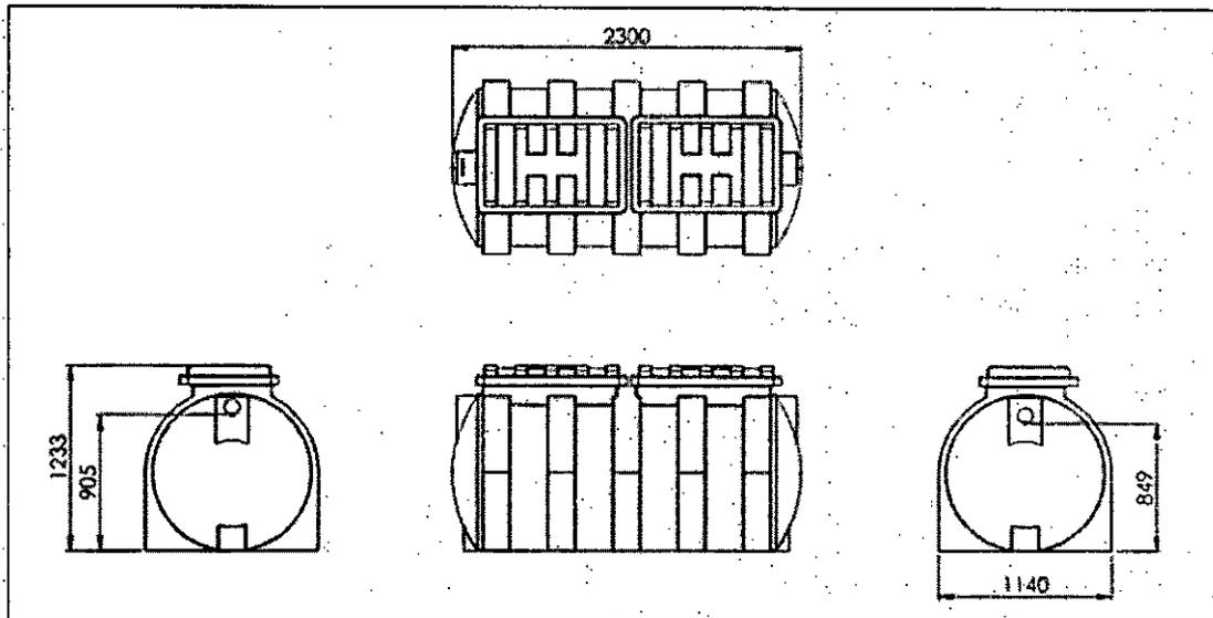
**Imagen 2. Tanque séptico prefabricado**
