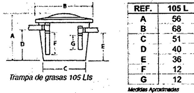
Imagen 2. Trampa de grasas prefabricada
