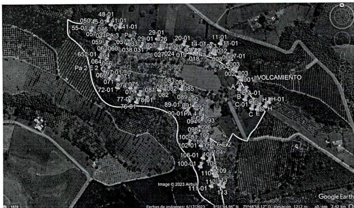
*Verificación De Coordenadas de Puntos De Levantamiento
