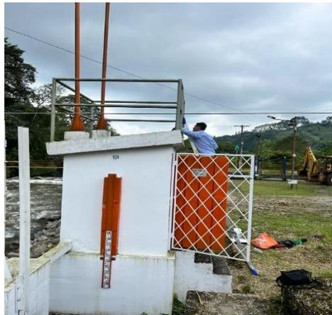
Mantenimiento a la red de estaciones hidrometeorológicas automáticas de la entidad y descarga de datos como respaldo técnico de la información.
