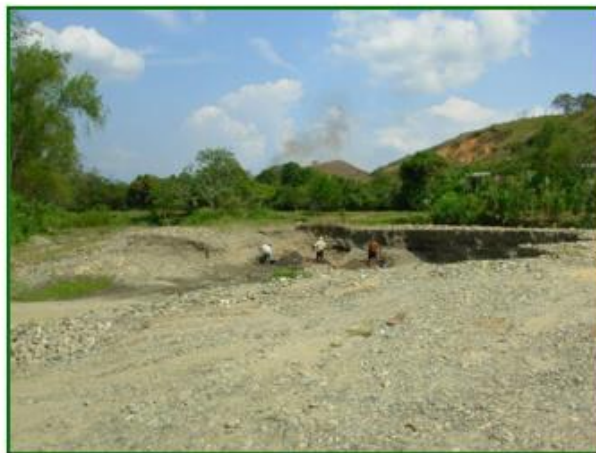
Fotografía 1 Forma de trabajo manual en el cauce seco del río, en las zonas de depositación que el río no ha dejado en la época invernal (Tomado de PMA, 2016).
