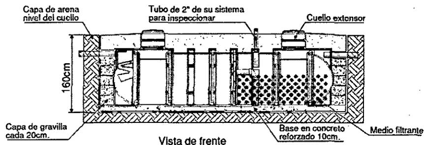
Imagen 2. Esquema corte de sistema de tratamiento.
