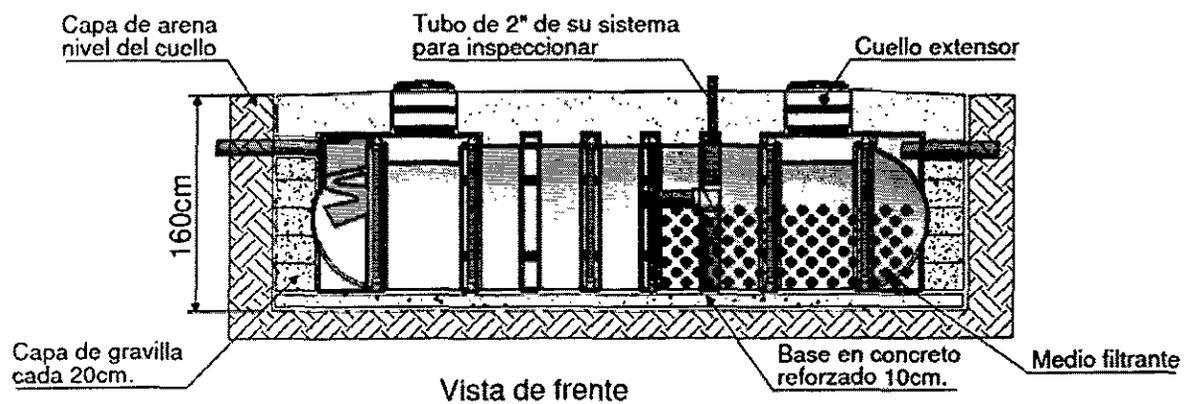
Imagen 2. Esquema corte de sistema de tratamiento.
