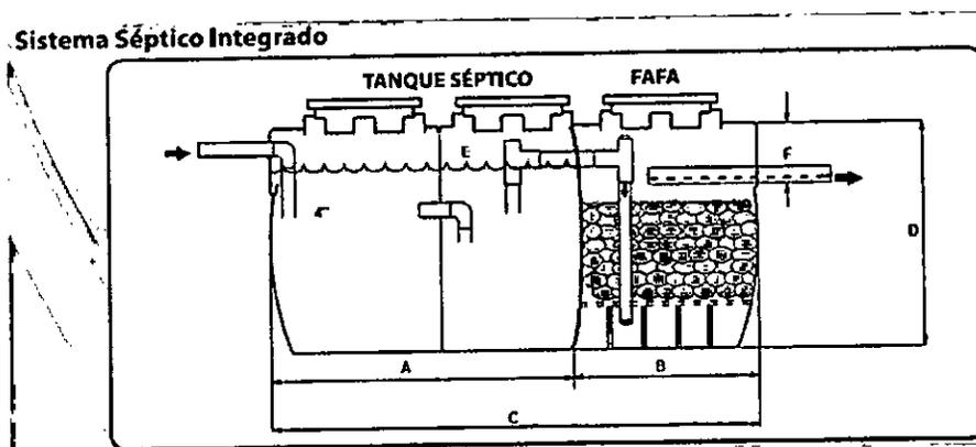
Imagen 1. Esquema corte de Tanque Séptico y FAFA.
