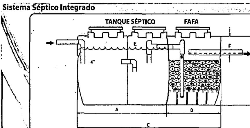
Imagen 1. Esquema corte de Tanque Séptico y FAFA.
