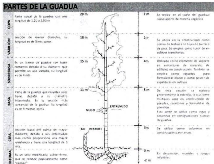
**Figura 12. Partes de la Guadua. Fuente. MANEJO Y PROTECCIÓN DE GUADUALES: Conversatorio con actores interesados en su conocimiento y conservación, CVC, 2021.**
