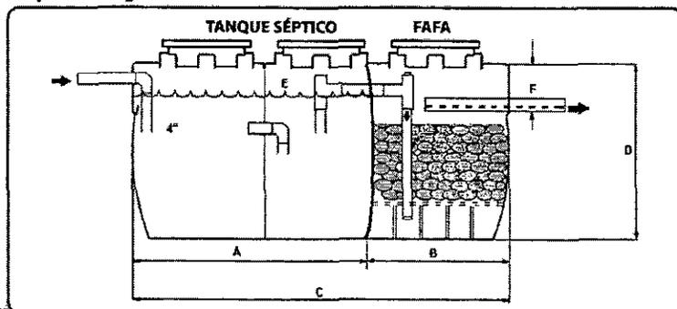
Imagen 1. Esquema corte de Tanque Séptico y FFA.
