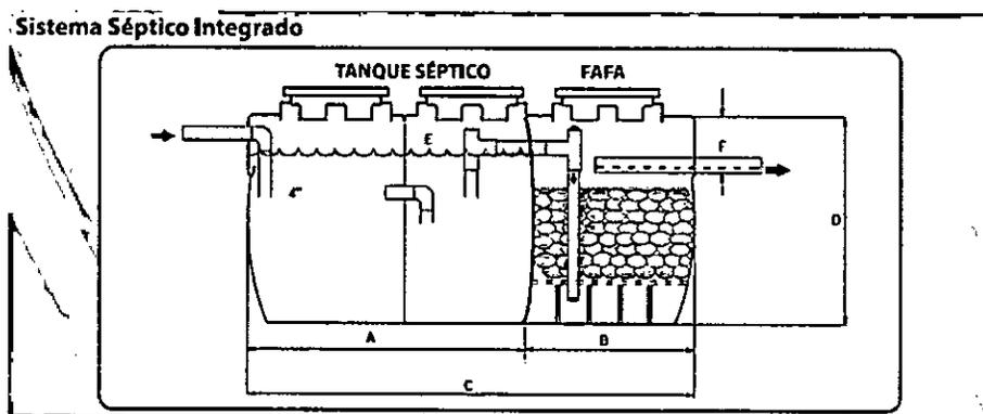
Imagen 1. Esquema corte de Tanque Séptico y FFA.
