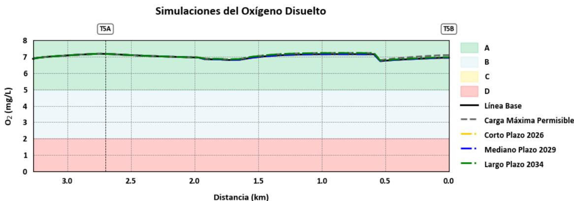
Figura 155. Resultados de las Simulaciones para el Oxígeno Disuelto en la Quebrada La Silenciosa
