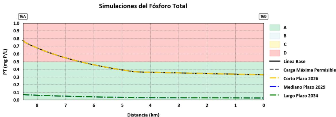
Figura 168. Resultados de las Simulaciones del Fósforo Total en la Quebrada Mina Rica
