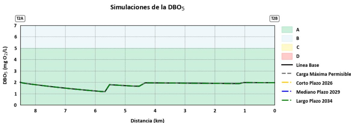
Figura 170. Resultados de las Simulaciones para la  $DBO_5$  en la Quebrada Bambuco
