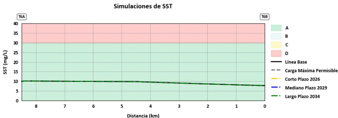
Figura 161. Resultados de las Simulaciones para los SST en la Quebrada Mina Rica
