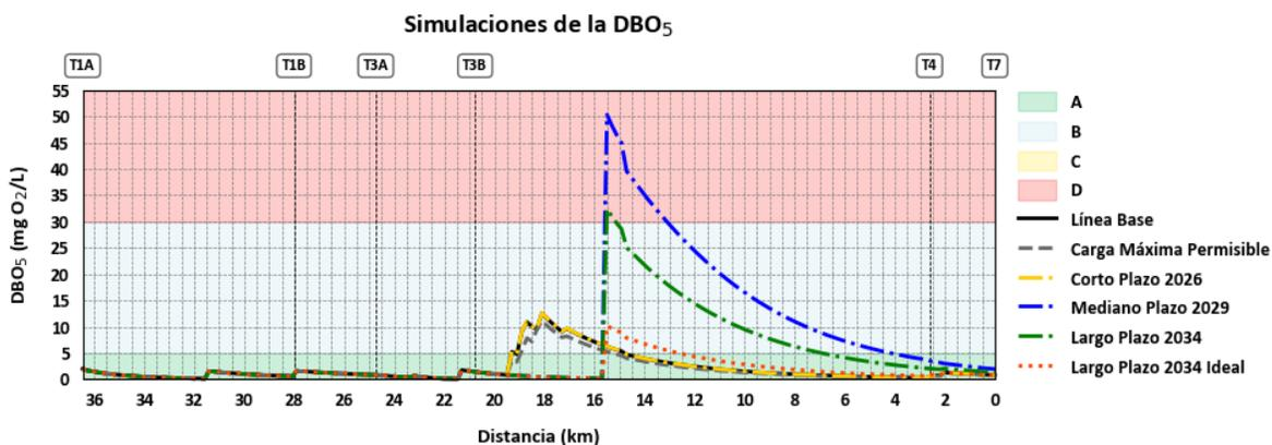
Figura 146. Resultados de simulación para DBO<sub>5</sub> en la Quebrada Buenavista
