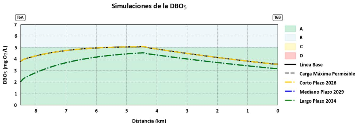
Figura 162. Resultados de las Simulaciones para la DBO<sub>5</sub> en la Quebrada Mina Rica
