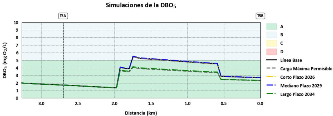
Figura 154. Resultados de las Simulaciones para la DBO<sub>5</sub> en la Quebrada La Silenciosa
