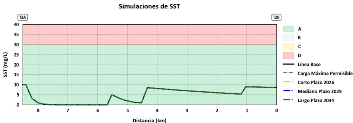
Figura 169. Resultados de las Simulaciones para los SST en la Quebrada Bambuco
