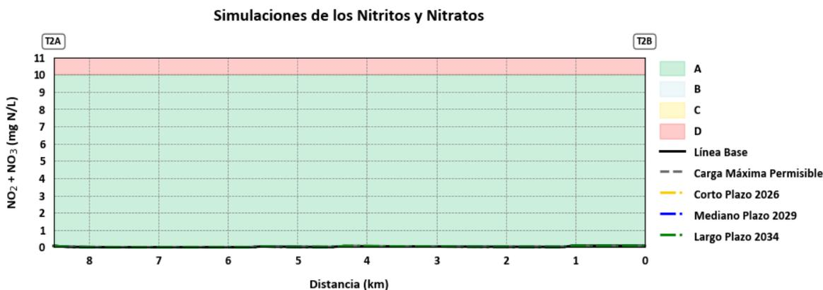
Figura 175. Resultados de las Simulaciones del nitrito y nitrato en la Quebrada Bamucu
