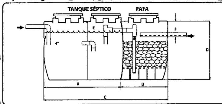
Imagen 1. Esquema corte de Tanque Séptico y FAFA.
