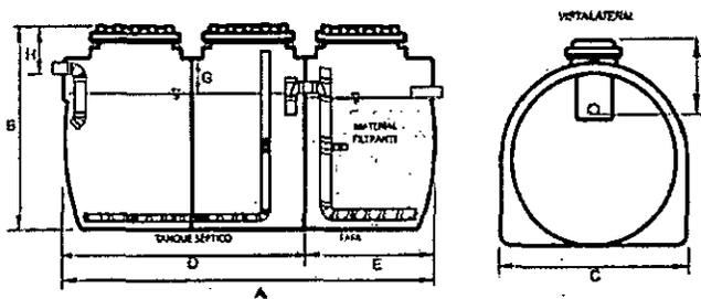
Imagen Alternativa N° 2, sistema séptico integrado de 2000 L de capacidad
