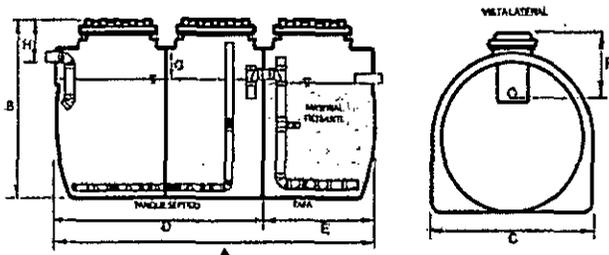
*Diagrama Resolutorio N° 2, sistema séptico integrado de 7500 lts autolimpiante*
