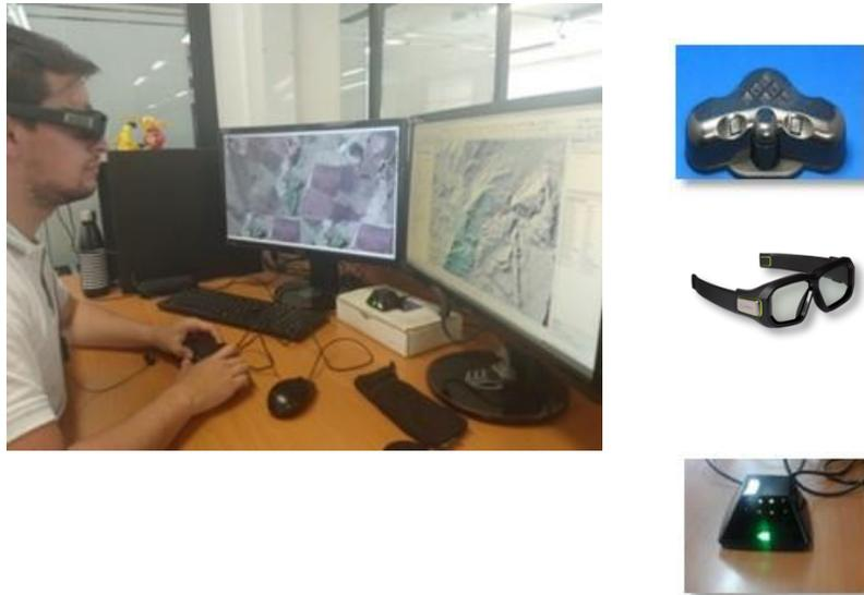
Figura 35. Estación de trabajo para la captura de información con estereoscopia digital.
