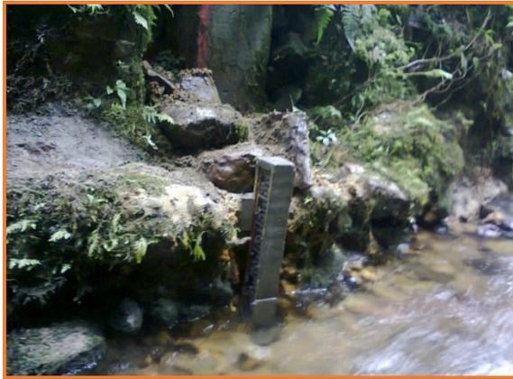
Mira Limnimétrica margen derecha Aguas abajo
