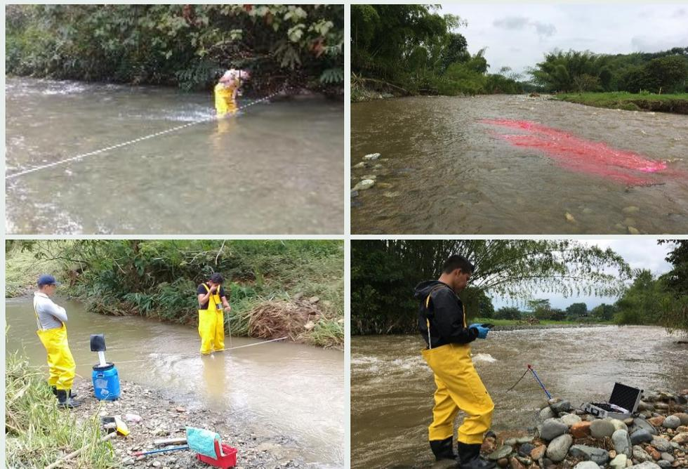
Figura Medición de caudal mediante diferentes métodos
