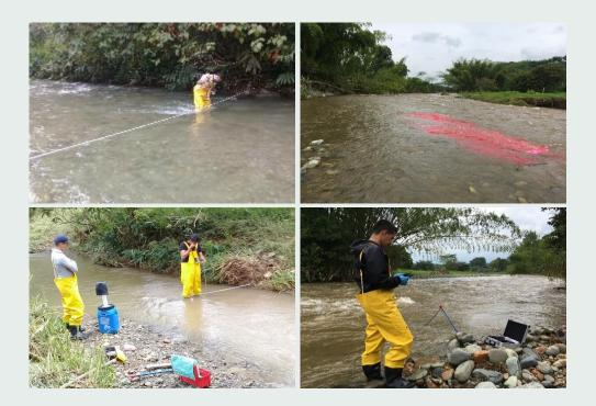
Figura Medición de caudal mediante diferentes métodos
