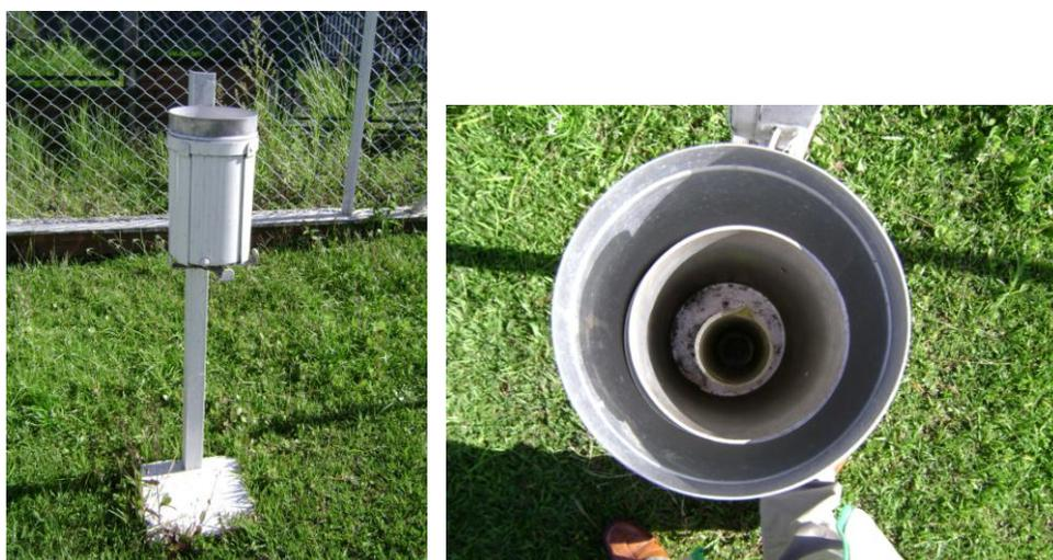
Fig. 1 Pluviómetro (PM), versión Hellmann
