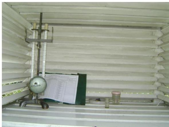
Fig. 5 Caseta Meteorológica en la cual se dispone el Psicrómetro.
